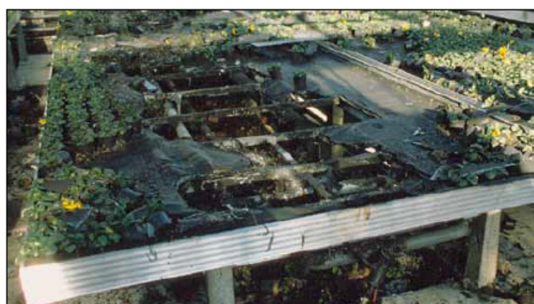
Foto 2: I rivestimenti dei bancali in materiale sintetico sono infiammabili e provocano la diffusione di fiamme.
